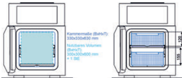
BlueLine 65 T: Verwendung von Gitter-Einsatzkörben, kubisch [mm]
